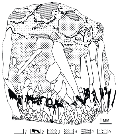
Рисунок 4. Призальбандовый участок жилы: гребенчатый кварц 1 с зоной расщепления и густо замутнения флюидными включениями 2 цементируется микрозернистым гипидиоморфным кварцем с обломками пород размерами до 0,02 мм 3 и до 1 мм 4, а затем перекрывается кокардовой брекчией (5 – наиболее крупные обломки пород) с поздним мелкогоребенчатым кварцем (6, черное – густо замутнение флюидными включениями) / Figure 4. Near-wall vein portion.
