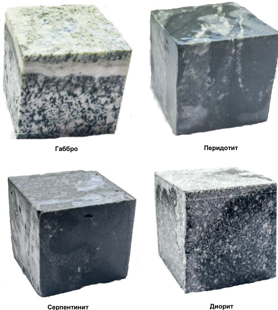
Рисунок 3. Образцы вскрышных горных пород карьера АО «Ураласбест», подготовленные для испытаний Figure 3. Samples of overburden rocks of the quarry of AO Uralasbest, prepared for testing
