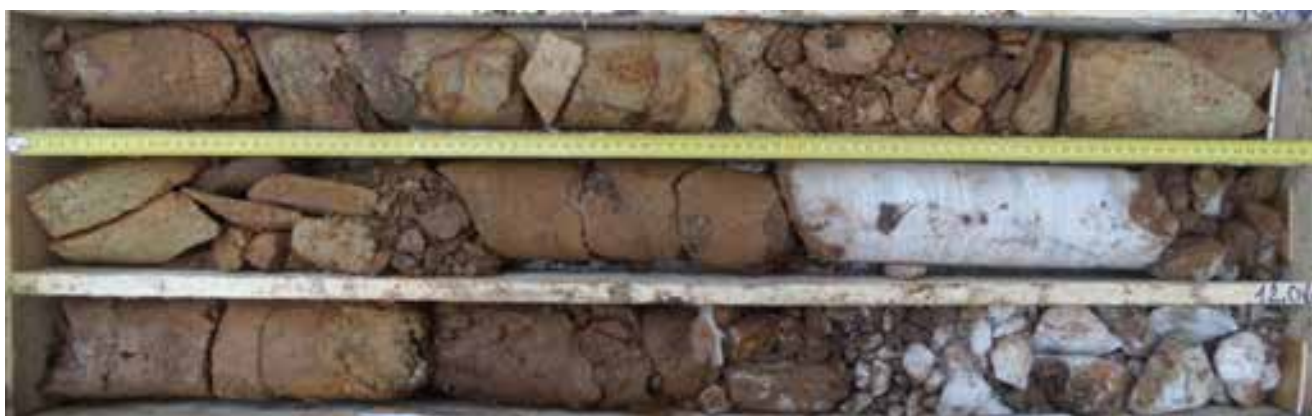
Рисунок 5. Обломочная зона. Figure 5. Rubble zone.
