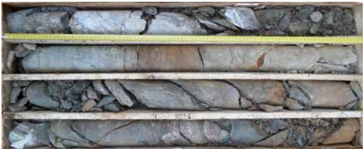
Рисунок 6. Интенсивно трещиноватые породы. Figure 6. Heavy fractured rocks.
