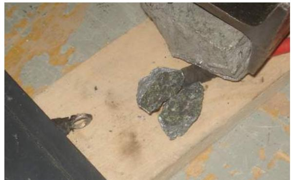
Рис. 4. Разрушение куска при воздействии электрического заряда
