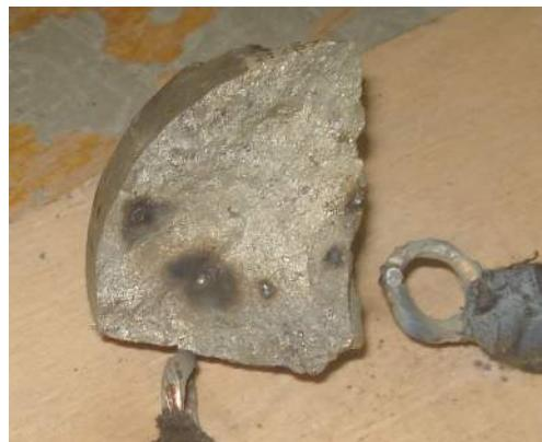
Рис. 3. Зоны пробоя куска при воздействии электрического заряда
