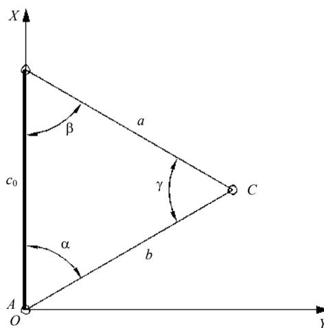
Рис. 1. Схема определения координат точки  $C$
