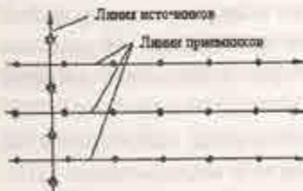
Рис.1. Схема ортогонального расположения линий приемников и источников колебаний при 3D
