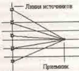
Рис.2. Направление прихода отраженных волн в точку приема при 3D-работах
