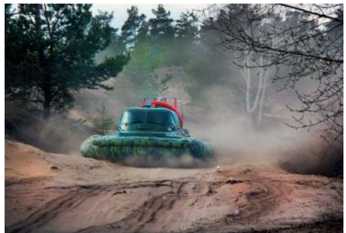
Рисунок 2. ТСВП – судно на воздушной подушке СЛАВИП / Figure 2. A vehicle with high cross – hovercraft SLAVIP.
