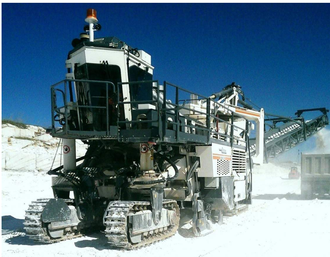
Рис. 1. Комбайн Wirtgen 2500 SM на Коелгинском месторождении мрамора
