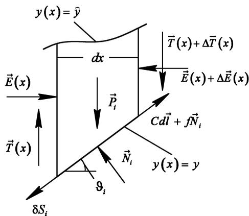
Рис. 1. Элементарный отсек и действующие на него силы
