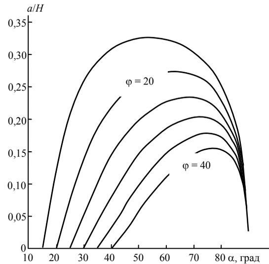
Рис. 6. Номограмма для определения ширины призмы обрушения
