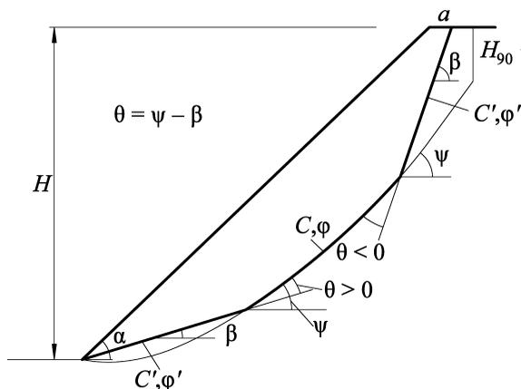
Рис. 8. Поверхность скольжения в анизотропном откосе
