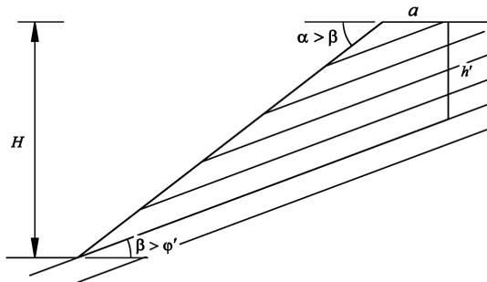
Рис. 7. Схема к расчету предельных параметров анизотропного откоса
