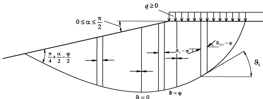
Рис. 3. Распределение реакций на различных участках поверхности скольжения
