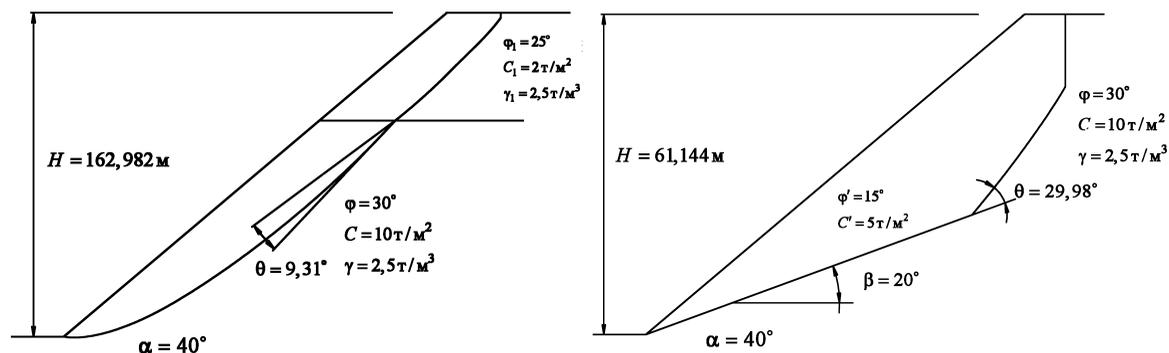
Рис. 9. Примеры расчета неоднородного и анизотропного откосов
