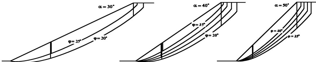
Рис. 4. Поверхности скольжения в плоских однородных откосах
