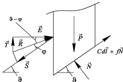
Рис. 2. Направление межблоковой реакции
