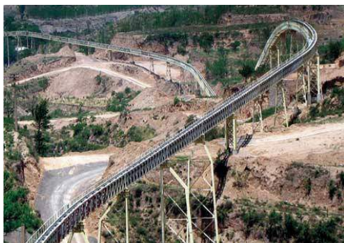
Рис. 4. Трубчатый конвейер для транспортирования гипса (Китай)
