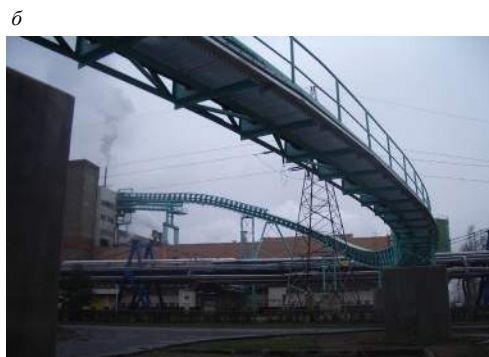
Рис. 3. Установка трубчатых ленточных конвейеров: а – в галерее фирмы КОСН (Германия), транспортирование сжиженного угля на ТЭЦ; б – на поверхности угольной шахты [2]
