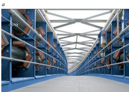
Рис. 3. Установка трубчатых ленточных конвейеров: а – в галерее фирмы КОСН (Германия), транспортирование сжиженного угля на ТЭЦ; б – на поверхности угольной шахты [2]
